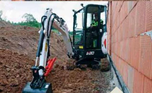
Das Zero House Swing-Konzept (ZHS, Bagger ohne Hecküberhang) ist eine Weiterentwicklung der Zero Tail Swing-Funktionalität (ZTS, Bagger in Kurzheckbauweise). Es schützt die Ecken des Oberwagenvorderteils besser, weil diese sich innerhalb des Schwenkkreises drehen. Die ZHS-Funktionalität sorgt bei Arbeiten in der Nähe eines Objektes für 320° freie Drehung.
